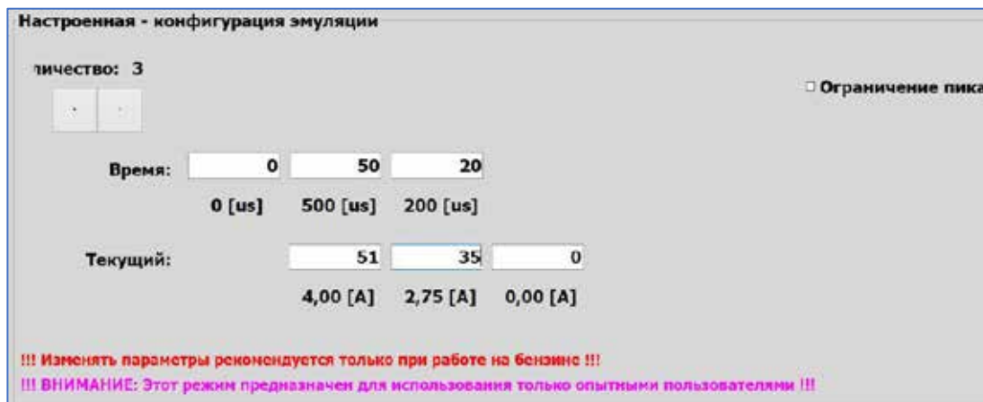
Рис. 2.107 Окно эмуляции бензиновых инжекторов с выбранной настройкой
