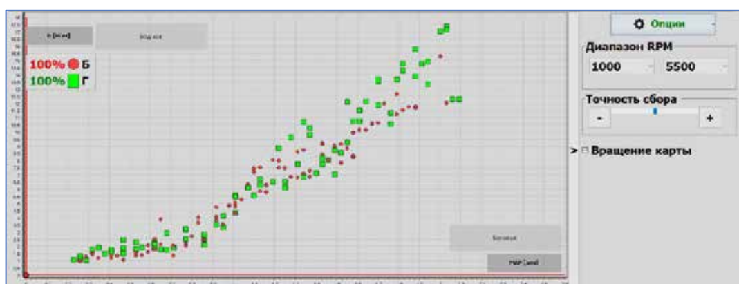
Рис. 2.94 Пример собранной карты газа и ранее собранной карты бензина
