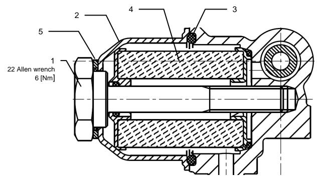
Отделите использованную бумажную гильзу (4) от длинной резьбы и удалите её. Далее следует выкрутить болт из алюминиевой чашки: теперь металлическая/ резиновая прокладка (5) в основании шестигранной гайки готова к замене (D).
