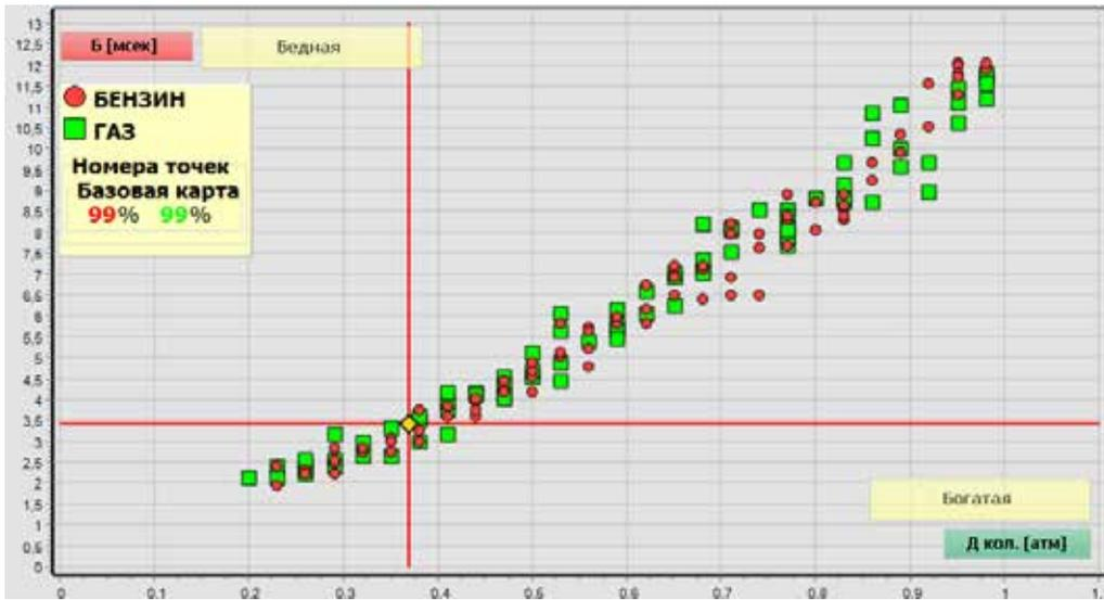
Теперь переключитесь на газ и соберите газовую карту. Вам просто нужно ездить на газе, стараясь держать двигатель в выбранном диапазоне оборотов, например:
