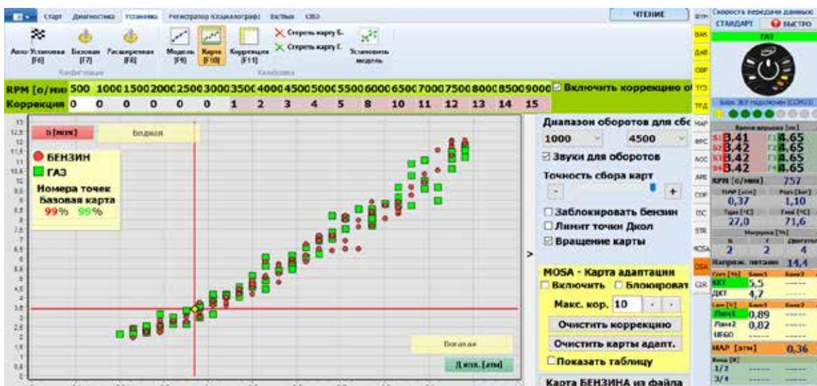
Во время дорожных испытаний, газовый ЭБУ получает время впрыска газа при различном разрежении/давлении воздуха во впускном коллекторе. Точки красного цвета получены во время работы на бензине и составляют бензиновую карту, а точки, полученные при езде на газе, составляют газовую карту и окрашены в зеленый цвет.
